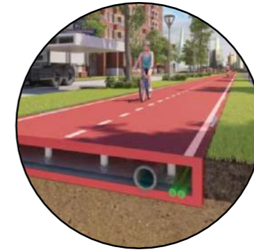
Cyklotrasa PlasticRoad vyrobená z recyklovaného plástu
